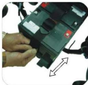
Dirección de fijado batería 36Ah
